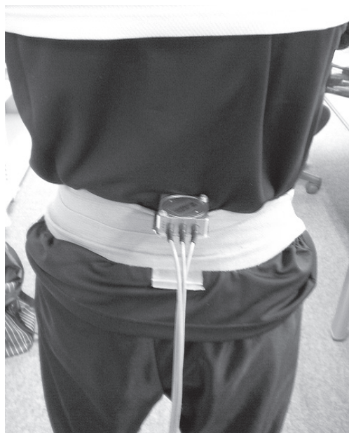
図1 加速度計の腰背部への装着
